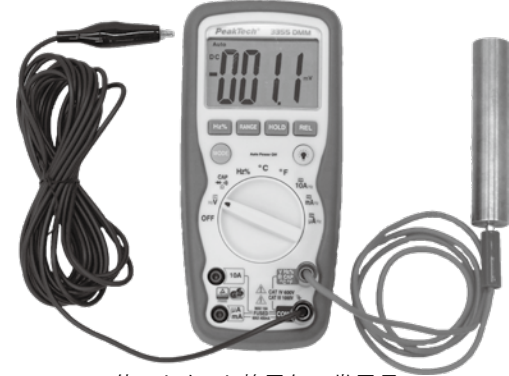
体にたまった静電気の帯電量を測る特殊な測定器
